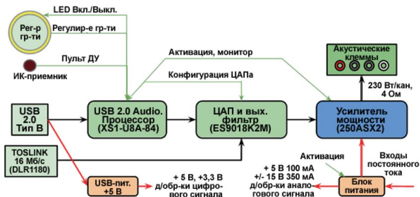
Рис 4. Блок-схема усилителя X725
