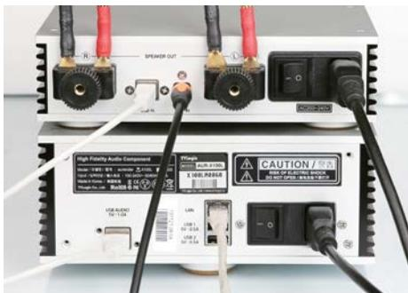
Рис. 10. Оптический SPDIF-вход можно использовать для подключения других источников — в дополнение к порту USB
