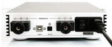
Рис. 6. Подключение к X725 сетевого кабеля 220 В
