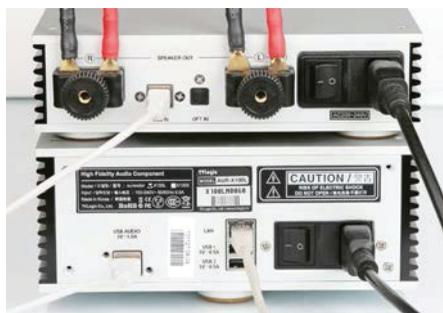
Рис. 9. Подключение X100 по USB
