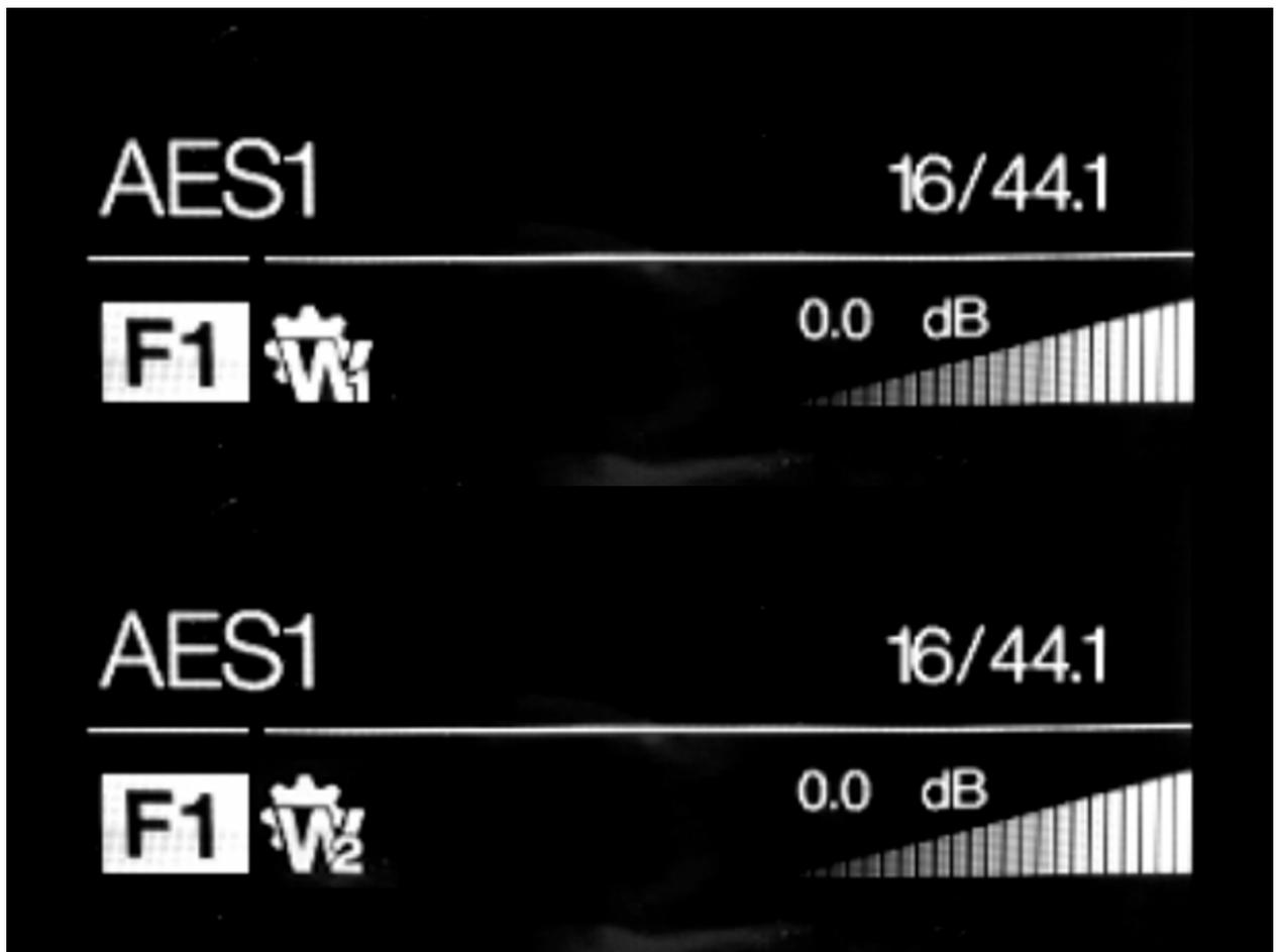
Чтобы подтвердить правильную работу, значок Word Clock Group 1 (W1) должен появиться для содержимого 44,1 кГц. Значок Word Clock Group 2 (W2) должен отображаться для основного контента 48 кГц. Он должен измениться автоматически непосредственно на ЦАП.
